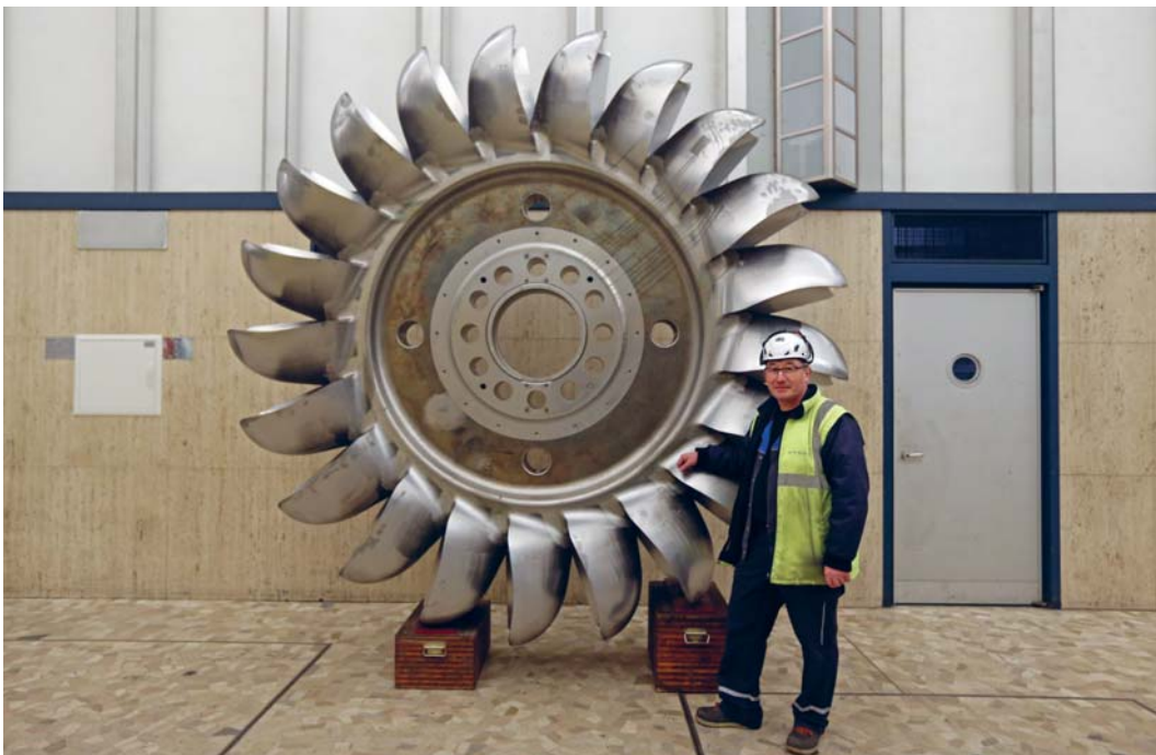
Rotor de turbine Centrale électrique de Nendaz
